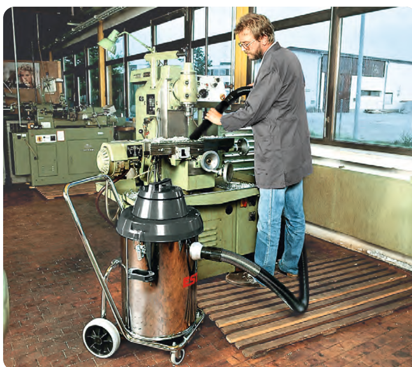
MULTISOG-4 an einem Bohrwerk
