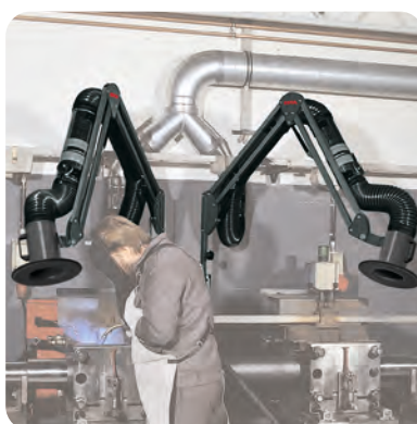
Absaugarme an einem Schweißplatz
