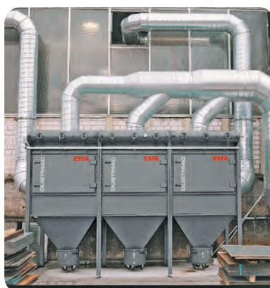
Modular aufgebaute Filtereinheit
