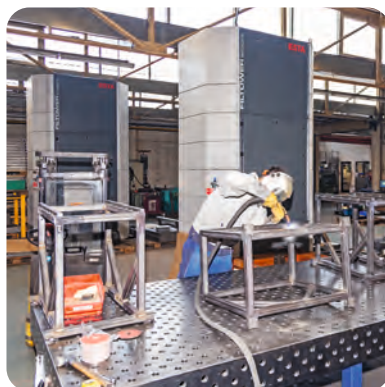
Zwei Filtertürme sorgen für saubere Luft in der Schweißerei
