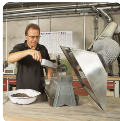
Quadratische Haube mit Prallblech an einer Wiegestation
