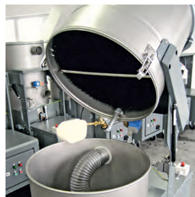
Abklippbares Geräteoberteil für einfachen Zugang ins Innere
