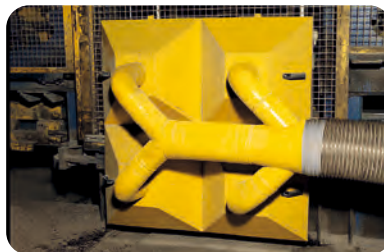
Großflächige Haube in der Betonindustrie
