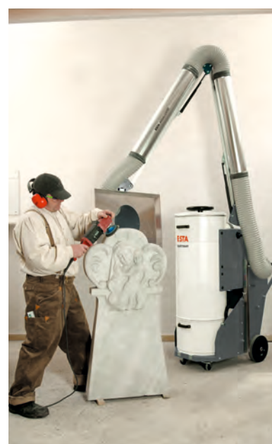
DUSTOMAT-16 M – direkte Absaugung des feinen Steinstaubes
