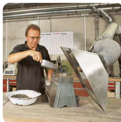
Quadratische Haube mit Prallblech an einer Wiegestation
