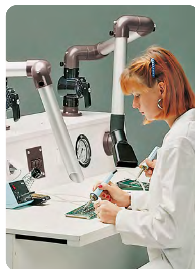
Mehrere Absaugarme für die Absaugung von Lötrauch
