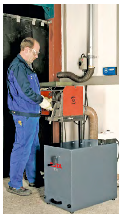
Kleinentstauber TK an einer Entgratmaschine
