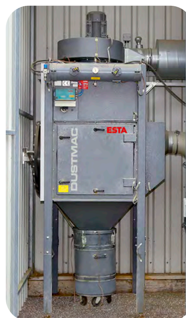
Absauganlage DUSTMAC F in der Chemie-Industrie
