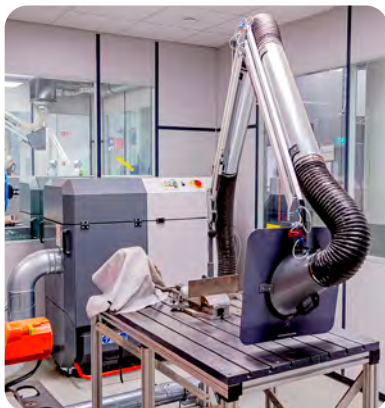
DUSTOMAT 24 – Absaugung in Roboterkabine
