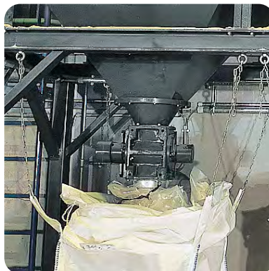
Austrag über Zellenradlschleuse in einen bauseitigen BigBag (optional)
