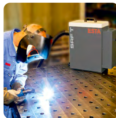
SRF T-2, Direktabsaugung an einem Schweißbrenner
