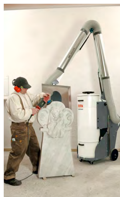
DUSTOMAT-16 M – direkte Absaugung des feinen Steinstaubes
