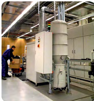
Filterzyklon FZ-1003 mit 100 Liter Sammelbehälter
