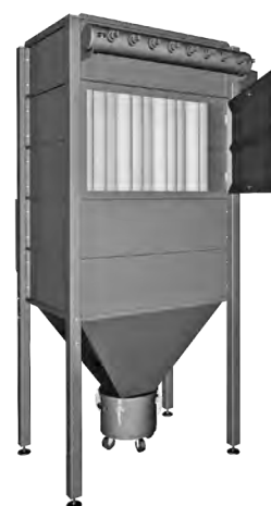
DUSTMAC S (mit Filterschlauch)
