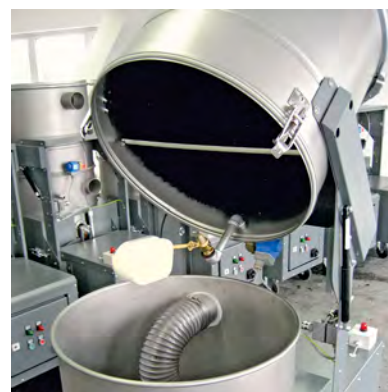
Abklippbares Geräteoberteil für einfachen Zugang ins Innere
