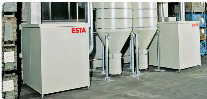
Hochdruckventilatoren in Verbindung mit zwei ESTA-Filterzyklonen
