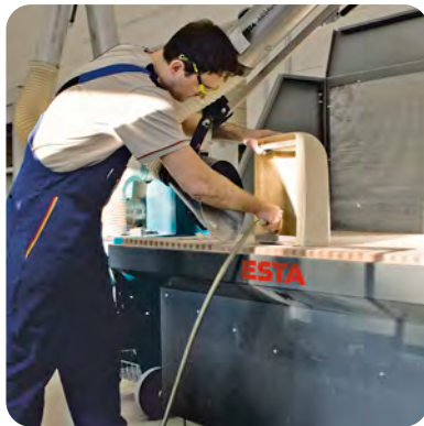
Absaugtisch mit Holzplattenrost und Absaugarm
