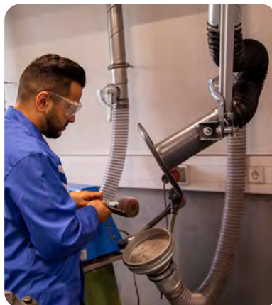
Absaugarm an Schleifarbeitsplatz
