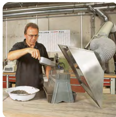
Quadratische Haube mit Prallblech an einer Wiegestation
