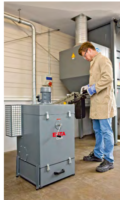
OM-8 an einer Bandschleifmaschine
