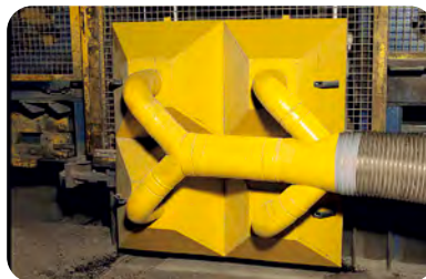
Großflächige Haube in der Betonindustrie
