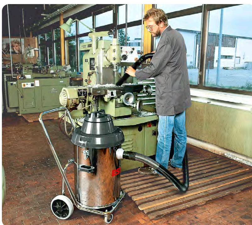
MULTISOG-4 an einem Bohrwerk
