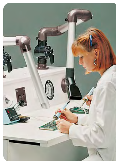
Mehrere Absaugarme für die Absaugung von Lötrauch
