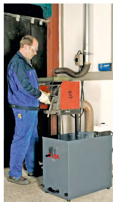
Kleinentstauber TK an einer Entgratmaschine
