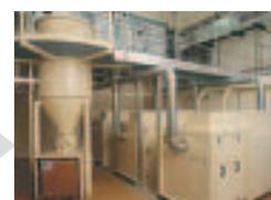
Hochvakuumsaugung zur Maschinenreinigung
