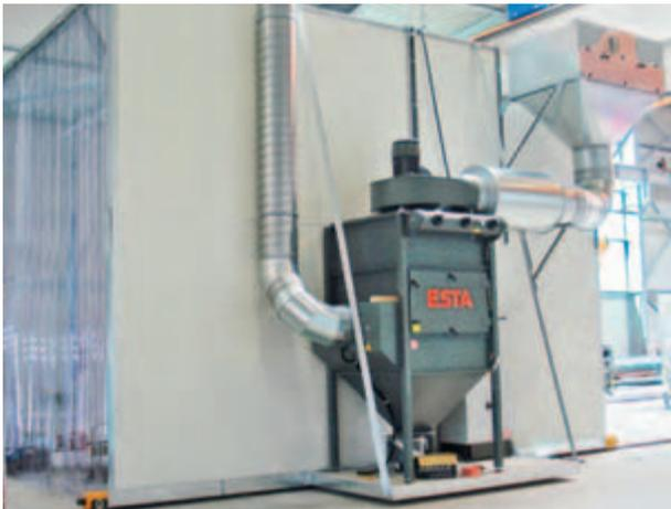
Fahrbare Schleifkabine zur Bearbeitung von Rotorblättern für Windkraftanlagen.
