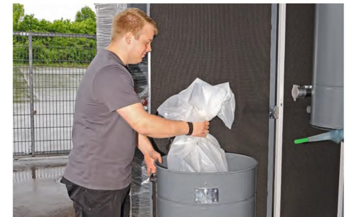
Der fahrbare Schmutzsammelbehälter mit eingelegtem Plastiksack gewährleistet eine schnelle und staubarme Entsorgung
