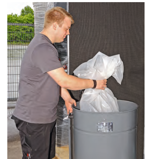
Der fahrbare Staubsammelbehälter mit eingelegetem Plastiksack gewährleistet eine schnelle und staubarme Entsorgung
