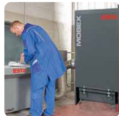
Die MOBEX-Entstauber können auch in Kombination mit einem ESTA Absaugtisch eingesetzt werden.
