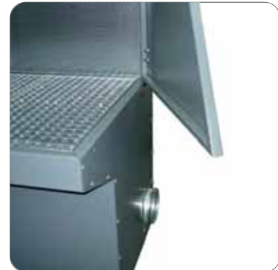
Aufgeklapptes Seitenteil für größere Werkstücke
