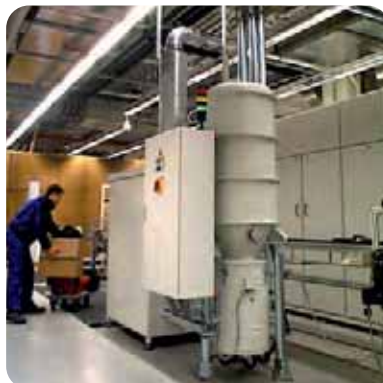
Filterzyklon FZ-1003 mit 100 Liter Sammelbehälter
