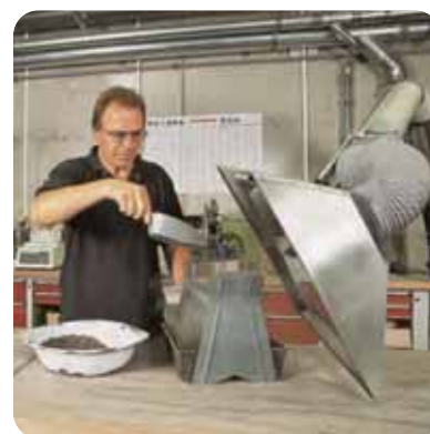
Quadratische Haube mit Prallblech an einer Wiegestation
