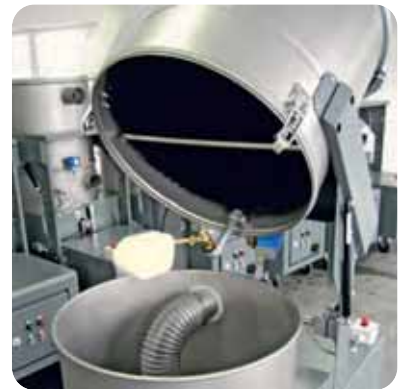
Abklippbares Geräteoberteil für einfachen Zugang ins Innere
