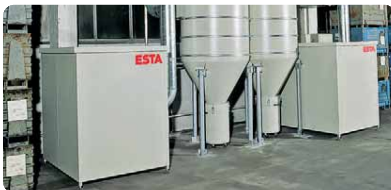
Hochdruckventilatoren in Verbindung mit zwei ESTA-Filterzyklonen
