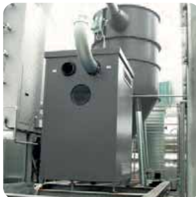
Filtereinheit mit Explosionsschutz
