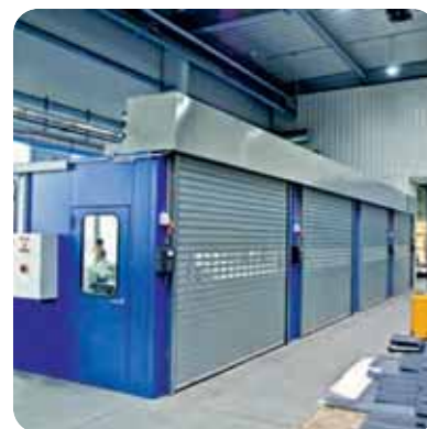
4-fach Schleifkabine mit Rolltoren
