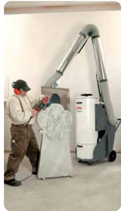
DUSTOMAT-16 M – direkte Absaugung des feinen Steinstaubes
