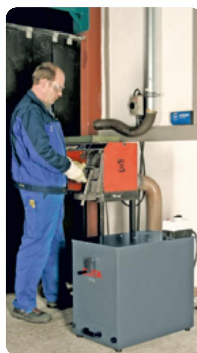
Kleinentstauber TK an einer Entgratmaschine
