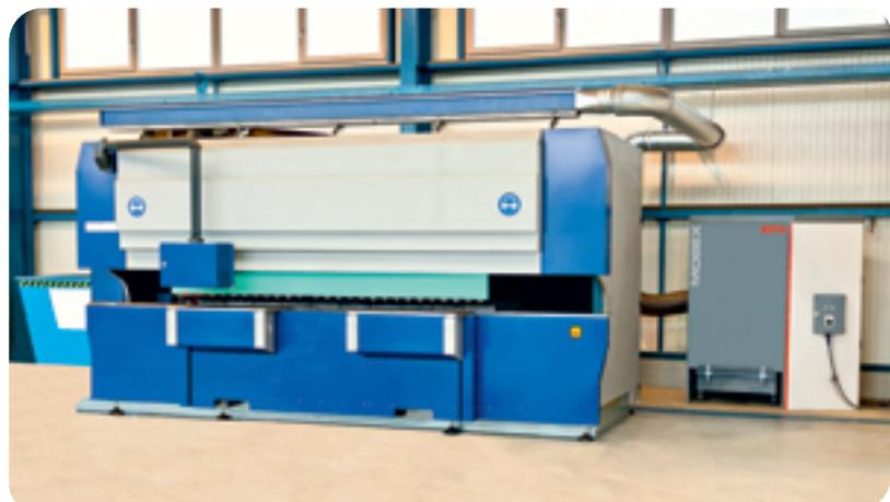
MOBEX P-24 an einer Fasen-Bandschleifmaschine.
