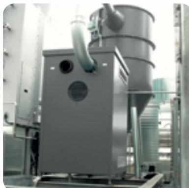
Filtereinheit mit Explosionsschutz
