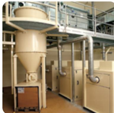
Filtersystem mit Staubaustrag über Zellrad-
