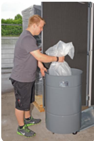
Der fahrbare Staubsammelbehälter mit eingelegtem Plastiksack ermöglicht die leichte und staubfreie Entsorgung des abgesaugten Schmutzes.
