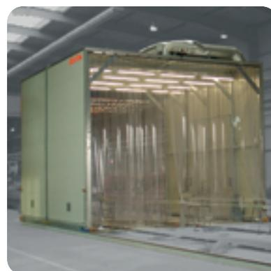
Fahrbare Absaugkabine für die Rotorblattfertigung
