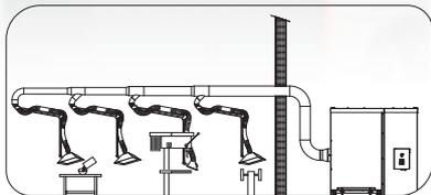
Die MOBEX-Serie kann mittels Rohrleitungen und Absaugarmen zur gleichzeitigen Absaugung an mehreren Arbeitsplätzen eingesetzt werden
