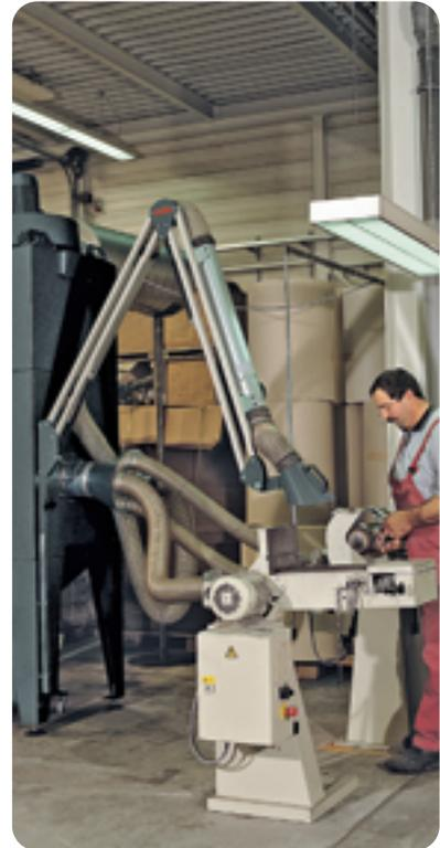
NA-K an einer Bandschleifmaschine
