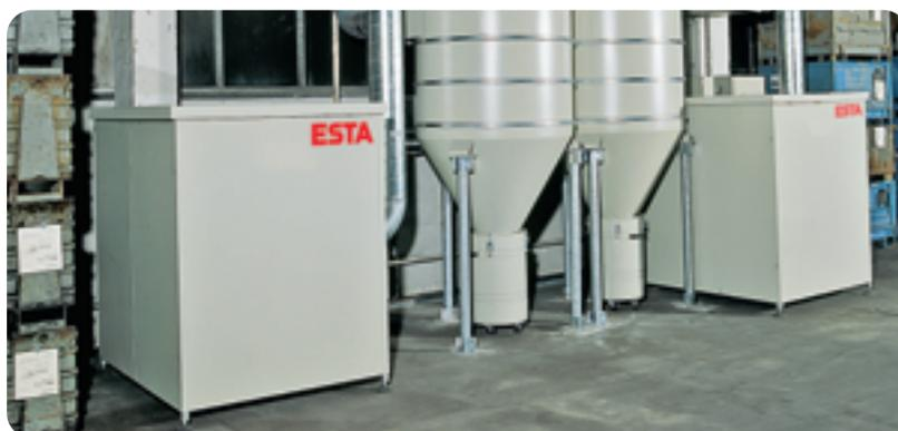
Hochdruckventilatoren in Verbindung mit zwei ESTA-Filterzyklonen
