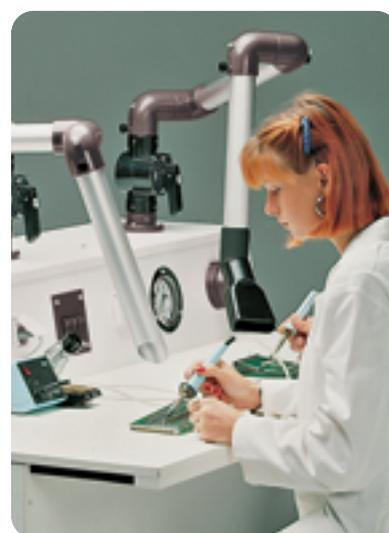
Mehrere Absaugarme für die Absaugung von Lötrauch
