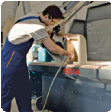
Absaugtisch mit Holzplattenrost und Absaugarm
