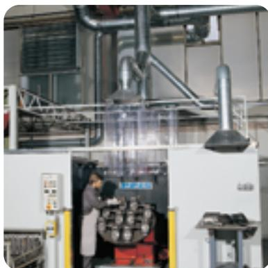
Absaugung an einem Roboterarbeitsplatz
