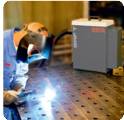
SRF T-2, Direktabsaugung an einem Schweißbrenner
