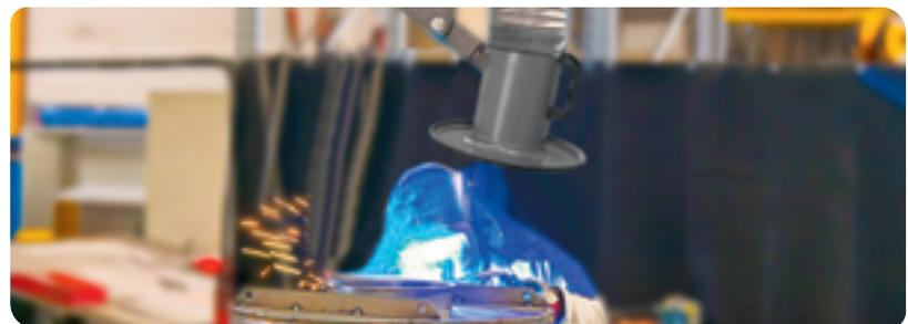
Für eine optimale Raucherfassung an bis zu vier Absaugstellen oder an kleineren Schweißkabinen bietet ESTA die stationäre Schweißrauchfilter-Serie **MOBEX F** an. Die „Einsteiger-Modelle“ im stationären Bereich eignen sich für Luftmengen bis zu 4.500 m<sup>3</sup>/h.
