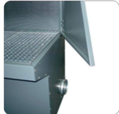
Aufgeklapptes Seitenteil für größere Werkstücke
