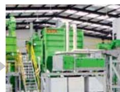
Staubabsaugung an einer WEEE-Recyclinganlage
