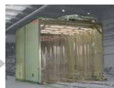
Fahrbare Kabine mit Absaugung in der Rotorblattfertigung
