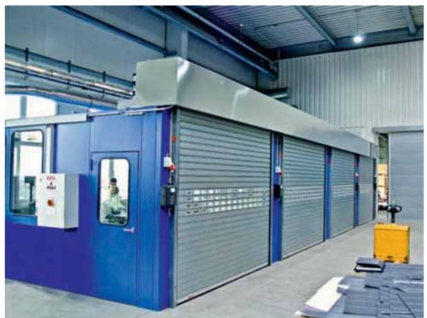
4-fach Schleifkabine mit Rolltoren für Produktionsprozesse in der Metallindustrie.
