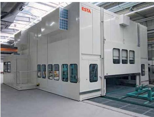
Kabine mit Belüftung an einem automatischen Bearbeitungszentrum.
