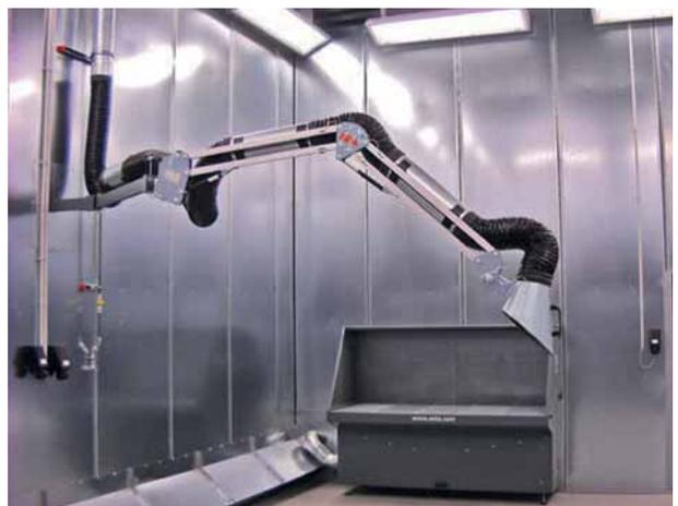
Absaugkabine mit integriertem Absaugtisch und -arm für Bearbeitungsprozesse in der Kunststoffindustrie.
