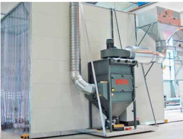
Fahrbare Schleifkabine zur Bearbeitung von Rotorblättern für Windkraftanlagen.
