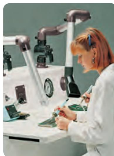
Mehrere Absaugarme für die Absaugung von Lötrauch
