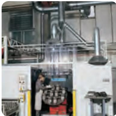
Absaugung an einem Roboterarbeitsplatz
