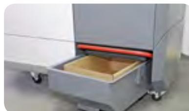
Die fahrbare 90-Liter Staubsammelschublade lässt sich auch mit Hubwagen oder Stapler transportieren.
