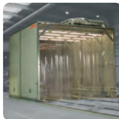
Fahrbare Absaugkabine für die Rotorblattfertigung
