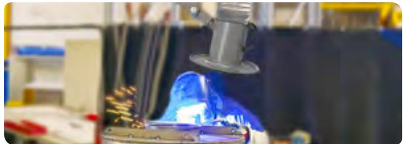
Mit den Hochvakuum-Schweißrauchfiltern der **SRF SK**-Serie kann an mehreren Schweißbrennern gleichzeitig abgesaugt werden.
