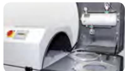
Die Oberseite des Filtermoduls ist aufklappbar und ermöglicht einen bequemen Zugang für Wartungsarbeiten.
