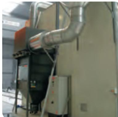
DUSTMAC Filtereinheit an Schleifkabine
