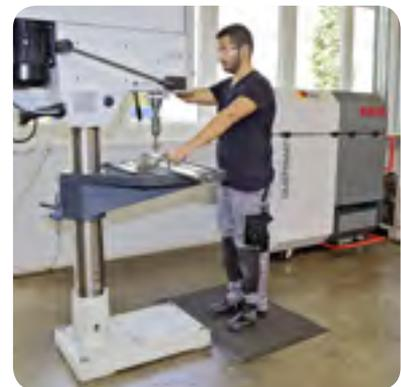
Der geringe Platzbedarf und das niedrige Betriebsgeräusch der Entstauber erlauben die Aufstellung direkt im Arbeitsbereich.
