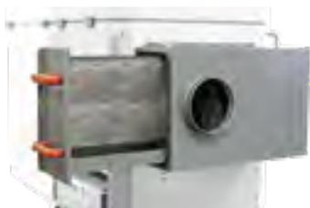
Die Entsorgung der Rückstände erfolgt durch das seitliche Entnehmen des Funkenvorabscheiders.
