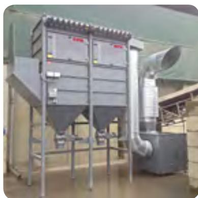
Absaugereinheiten DUSTMAC S-66 und Mitteldruckventilator
