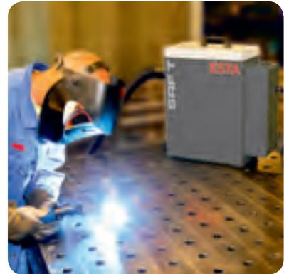
SRF T-2, Direktabsaugung an einem Schweißbrenner
