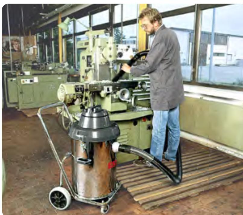
MULTISOG-4 an einem Bohrwerk
