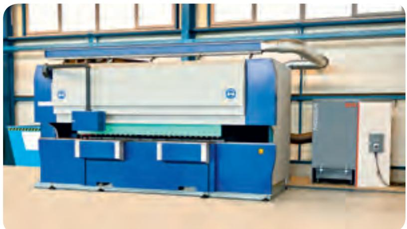
MOBEX P-24 an einer Fasen-Bandschleifmaschine.
