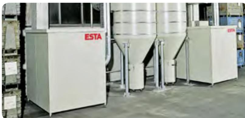
Hochdruckventilatoren in Verbindung mit zwei ESTA-Filterzyklonen
