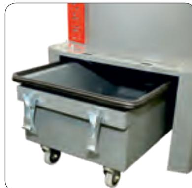
Die abkoppelbare Staub-Sammelschublade sorgt für eine einfache Entsorgung des Staubes
