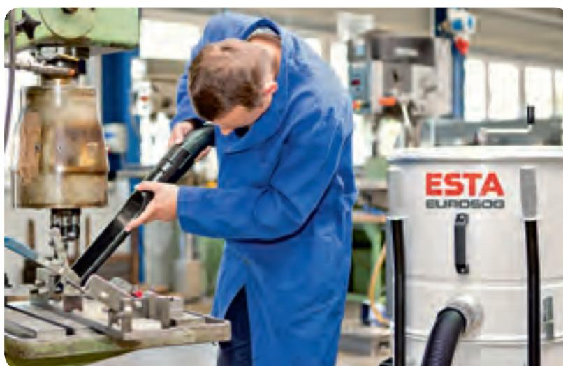
Mit der Schrägröhrendüse können selbst schwer zugängliche Stellen von Schmutz und Staub befreit werden
