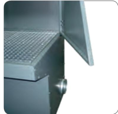
Aufgeklapptes Seitenteil für größere Werkstücke
