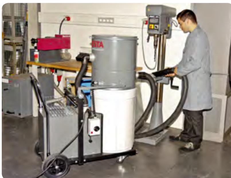
SPÄNESOG-S bei der Reinigung einer Bohrmaschine
