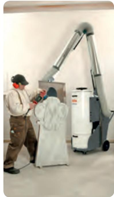
DUSTOMAT-16 M – direkte Absaugung des feinen Steinstaubes
