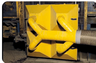
Großflächige Haube in der Betonindustrie
