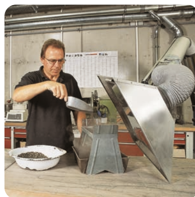
Quadratische Haube mit Prallblech an einer Wiegestation
