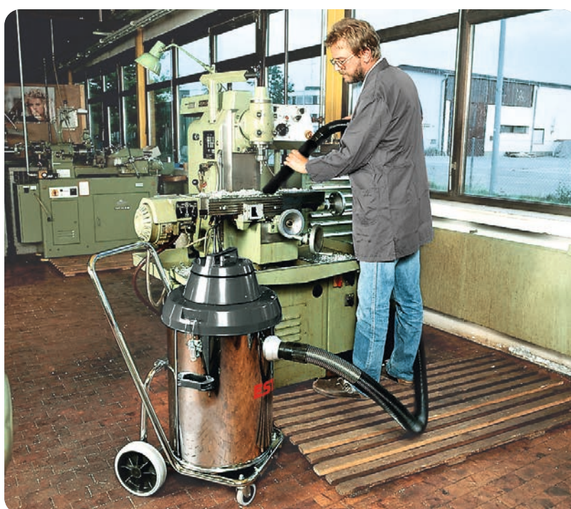
MULTISOG-4 an einem Bohrwerk
