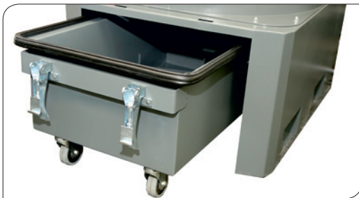
Die abkoppelbare Staub-Sammelschublade sorgt für eine einfache Entsorgung des Staubes
