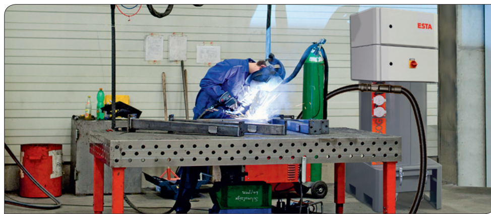
Der COMPASOG SR kann über ein Rohrsystem zur Absaugung an mehreren Arbeitsplätzen eingesetzt werden
