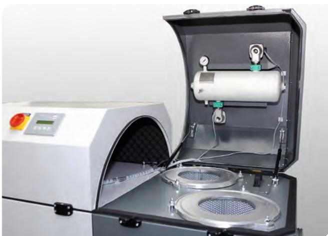
Die Oberseite des Filtermoduls ist aufklappbar und ermöglicht einen bequemen Zugang für Wartungsarbeiten.
