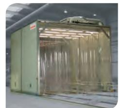
Fahrbare Kabine mit Absaugung in der Rotorblattfertigung
