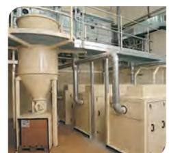
Hochvakuumabsaugung zur Maschinenreinigung
