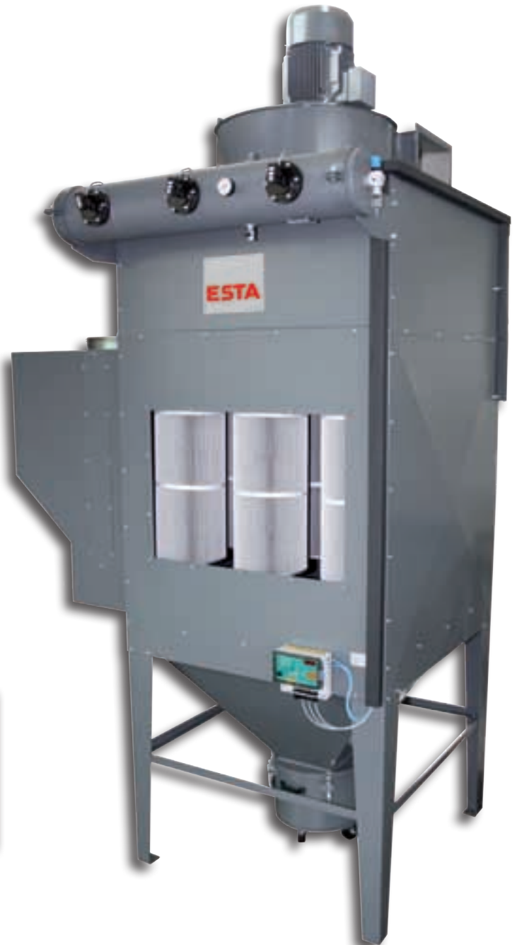
Prallabscheider als Option, zur Minderung des Brandrisikos
