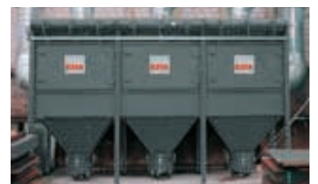
Filterelemente der ESTA Schweißrauchfilteranlagen WELDEX F und DUSTEX F können mehrfach und kostengünstig regeneriert werden.
