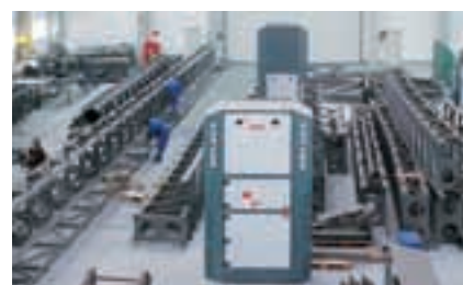
Filterelemente der ESTA Schweißrauchfilteranlagen WELDEX F und DUSTEX F können mehrfach und kostengünstig regeneriert werden.
