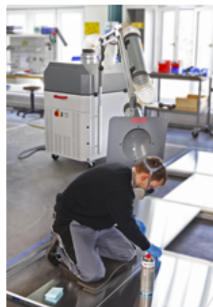
VACUMAT mit Absaugarm zur Absaugung an einem Klebearbeitsplatz
