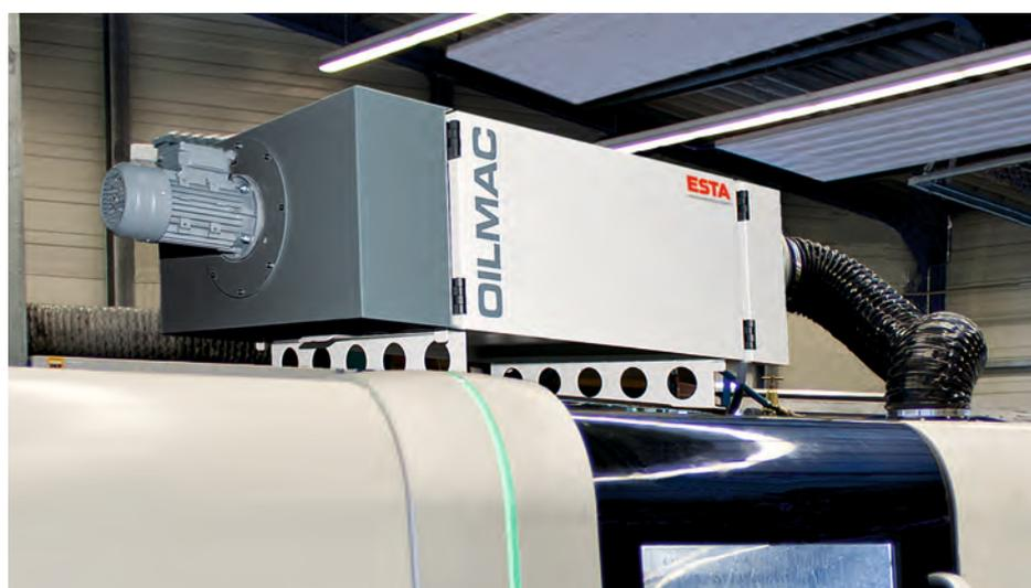
OILMAC 800 an einer Universal-Drehmaschine
