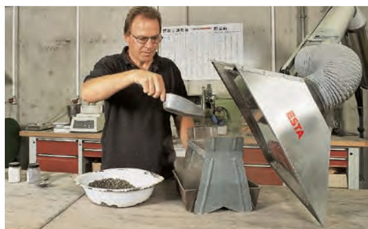
Absaugarm mit quadratischer Haube für die großflächige Absaugung von Staub bei einem Umfüllprozess in der Schüttgutindustrie
