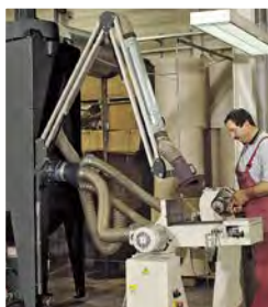
Absaugarm mit Düsenhaube bei einer Schleifanwendung
