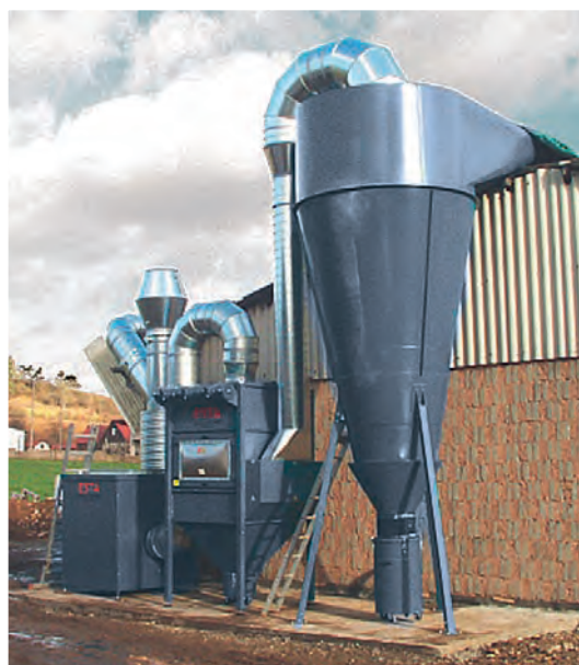
ESTA DUSTMAC F-144 mit Zyklonvorabscheider zur Absaugung von Zink und Baumwollfasern mit Polierwachs
