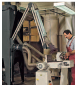
Absaugarm mit Düsenhaube bei einer Schleifanwendung
