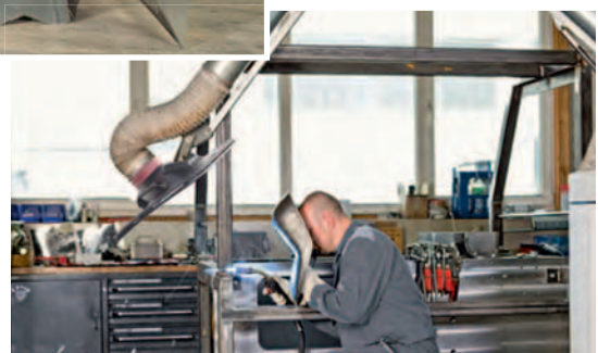
Absaugarme mit Effizienzhaube zur punktgenauen Erfassung von Schweißrauch
