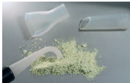
Fugendüse zur Absaugung von Pharmastäuben
