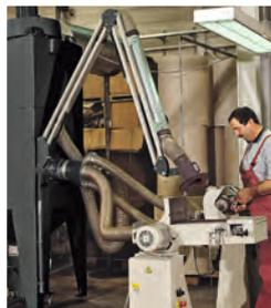
Absaugarm mit Düsenhaube bei einer Schleifanwendung
