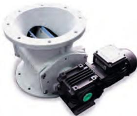
Der Typ ZRS8-250 bedient sich eines Flügelrades mit acht Kammern, das eine maximale Förderleistung von ca. 3.300 l/h erreicht. Dieser Typ ist für einen Austragsflansch von **DN 250 mm**, einem Unterdruck bis max. 20.000 Pa und dem Temperaturbereich von ca. -20 °C bis +80 °C ausgelegt. Der Befestigungsflansch entspricht der DIN2501 PN 10. Die ATEX-Ausführung kann in Zone 22 verwendet werden.
