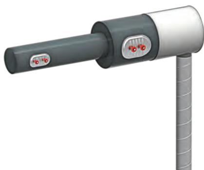
Das Rohrvorabscheidesystem scheidet Grobpartikel, glühende Teilchen und Funken effektiv bereits in der Rohrleitung ab und minimiert dadurch das Brandrisiko Ihrer Absaug- und Filteranlage. Der Rohrvorabscheider bietet nicht nur wirkungsvollen Schutz für Ihre Anlage, die Filterstandzeit wird darüber hinaus erheblich erhöht. Das System lässt sich einfach in die Rohrleitung integrieren – egal ob bei einer Neuinstallation oder Nachrüstung einer bestehenden Anlage.
