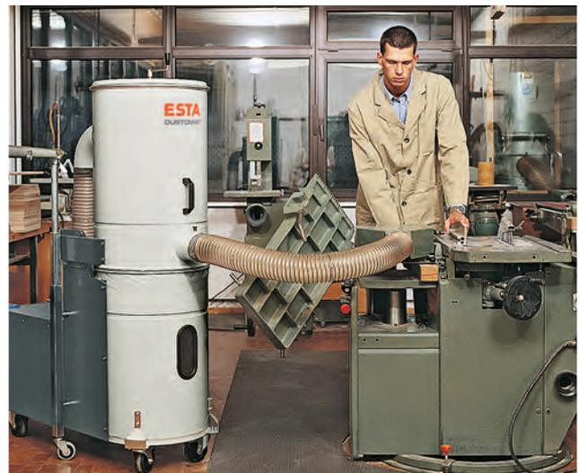
ESTA DUSTOMAT-10 mit PU-Schlauch an einer Kreissäge installiert zur Absaugung von Holzstäuben
