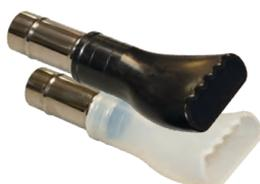
aus elektrisch leitfähigem Gummigemisch, inklusive Verbindungsrohr, Saugöffnung 110 × 25 mm, Gesamtlänge 270 mm
