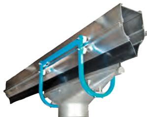
Das System AS 300 ist für die Saugwagen Ø 125 mm, Ø 150 mm und Ø 200 mm geeignet. Der max. Luftvolumenstrom beträgt ca. 2.500 m<sup>3</sup>/h. Querschnitt 300 cm<sup>2</sup>. Die Lieferlängen sind 4,0 m und 6,0 m.
