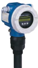
Der Ultraschallsensor sendet Impulse, die vom Schüttgut reflektiert werden. Die gemessene Zeit dient der Abstandsmessung. Bei Erreichen einer zuvor eingestellten Maximalentfernung gibt der Sensor ein Signal. Die ATEX-Ausführung kann in den Zonen 20/22 verwendet werden.
