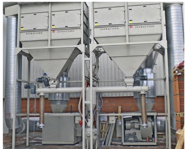
Zentrale Absauganlage mit zwei Zellenradschleusen zum kontinuierlichen Austrag von Ziegelstaub
