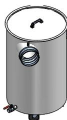
Zum Einsatz bei Funkenflug, 200l-Stahlbehälter mit abnehmbarem Deckel, optischer Füllstandskontrolle, Ablasshahn und 1,5m PU-Verbindungsschlauch
