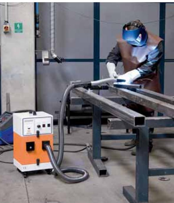
Bild 4: Hochvakuum-Punktabsaugung Quelle: KEMPER GmbH
