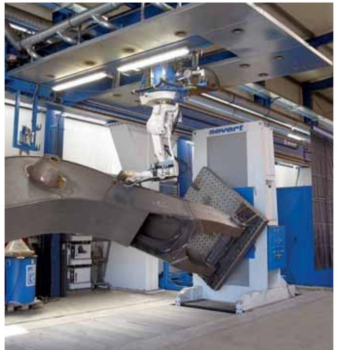
Bild 6: Absaughaube über Schweißroboter
