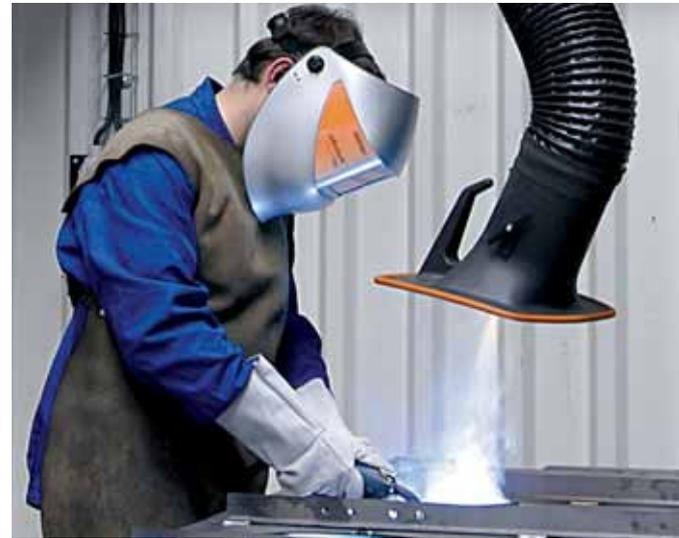
Bild 5: Absaughaube einer Niedrigvakuum- Punktabsaugung
