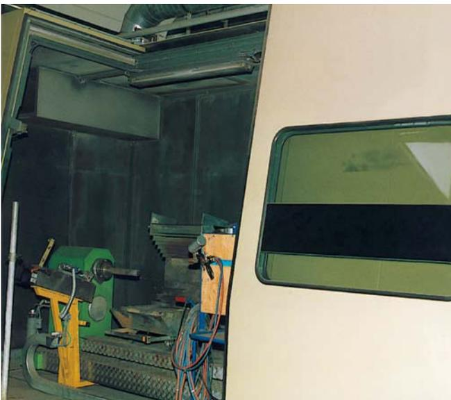
Bild 10-7: Geschlossene Kabine zum Plasmaspritzen
