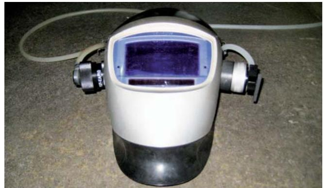
Bild 6-10: Schweißerschutzhelm mit integrierten Probenahmeköpfen PGP-EA und GSP für die gleichzeitige Probenahme
