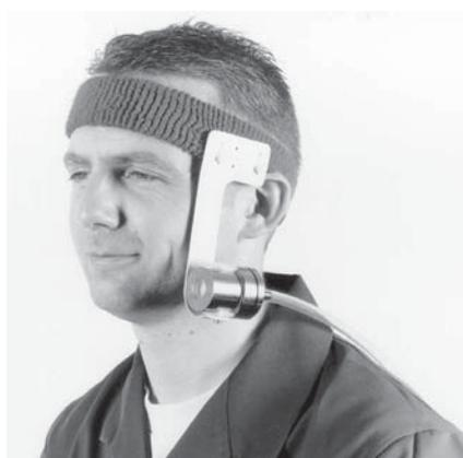
Bild 6-6: Schweißer, der eine am Sportler-Stirnband befestigte Probenahmeeinrichtung trägt
