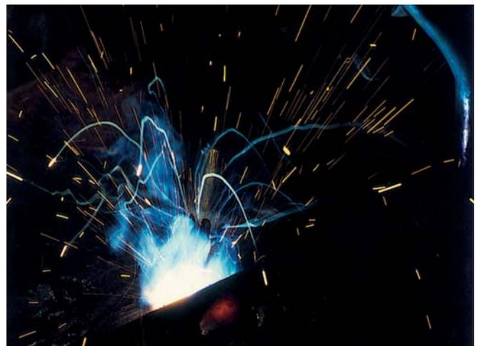
Bild 10-15 b: Brennerintegrierte Absaugung in Betrieb
