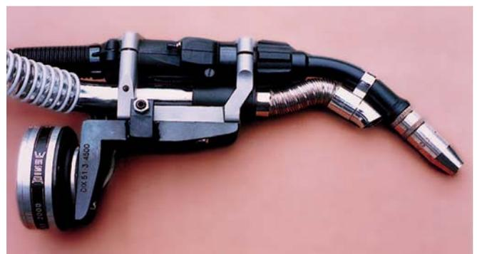
Bild 10-14: Brenner zum Metall-Schutzgasschweißen (MIG/MAG) mit integrierter Absaugung für automatisierte Anlagen
