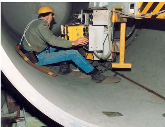
Bild 10-3: Unterpulverschweißen, ein schadstoffarmes Verfahren
