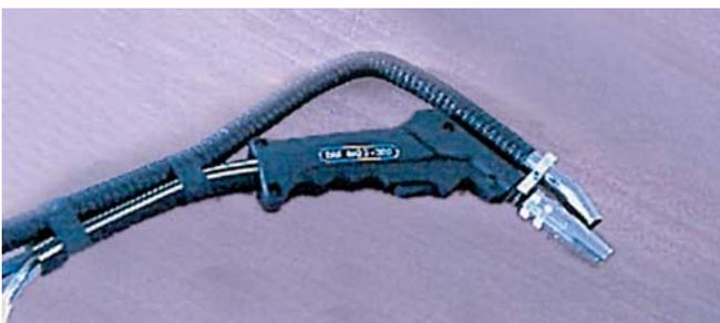
Bild 10-11: Erfassungselement am Brenner befestigt
