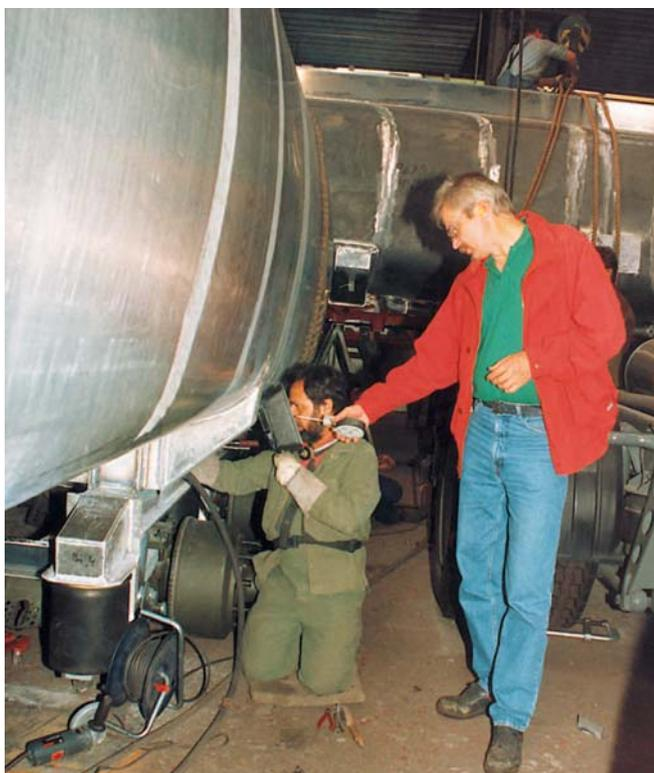
Bild 6-3: Messung von partikelförmigen Schadstoffen mit Hilfe eines personenbezogenen Staubsammelgerätes (PAS) sowie Prüfung auf gasförmige Schadstoffe mit Hilfe von Prüfröhrchen
