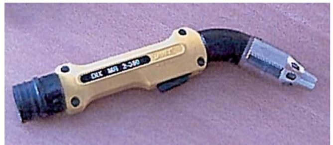
Bild 10-12: Brenner mit integrierter Absaugung
