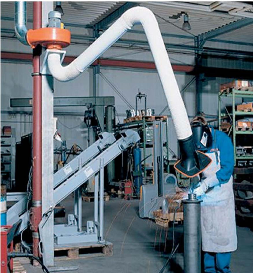
Bild 10-8: Beispiel einer stationären Absaugung
