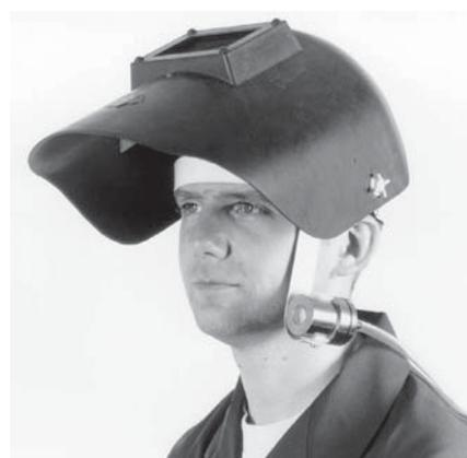
Bild 6-7: Schweißer, der eine am Sportler-Stirnband befestigte Probenahmeeinrichtung und einen Schweißer-Gesichtsschutzschirm trägt
