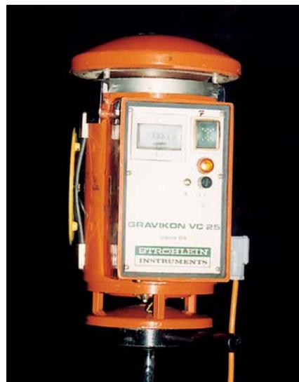
Bild 6-11: Stationäres Staubsammelgerät (VC 25) für die ortsfeste Probenahme (Messung) partikelförmiger Schadstoffe
