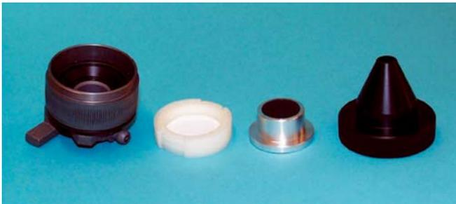
Bild 6-9: Zerlegter Probenahmekopf PGP-EA
