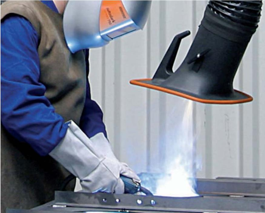
Bild 10-9: Metall-Schutzgasschweißen (MIG/MAG) mit Absaugung
