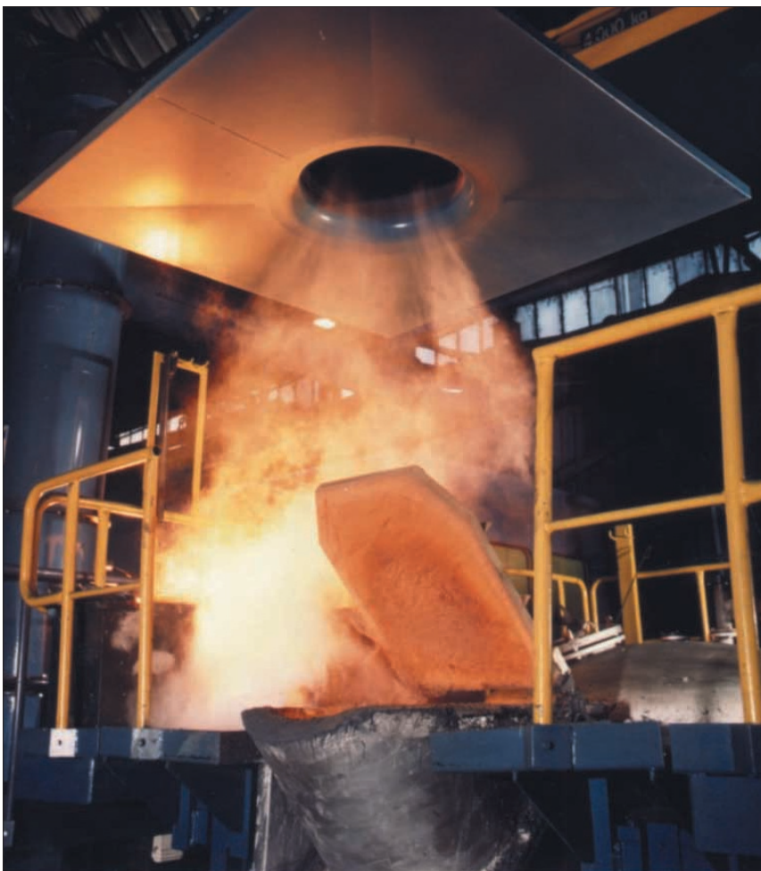
Bild 6: Düsenplatte zur Absaugung an Schmelzriegeln
