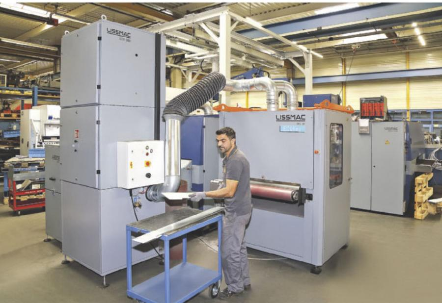
Die bei Schleif- und Entgratmaschinen entstehenden Stäube werden mit Trocken- oder Nassabscheidern (links im Bild) abgesaugt. (Bilder: Ott/Esta)
