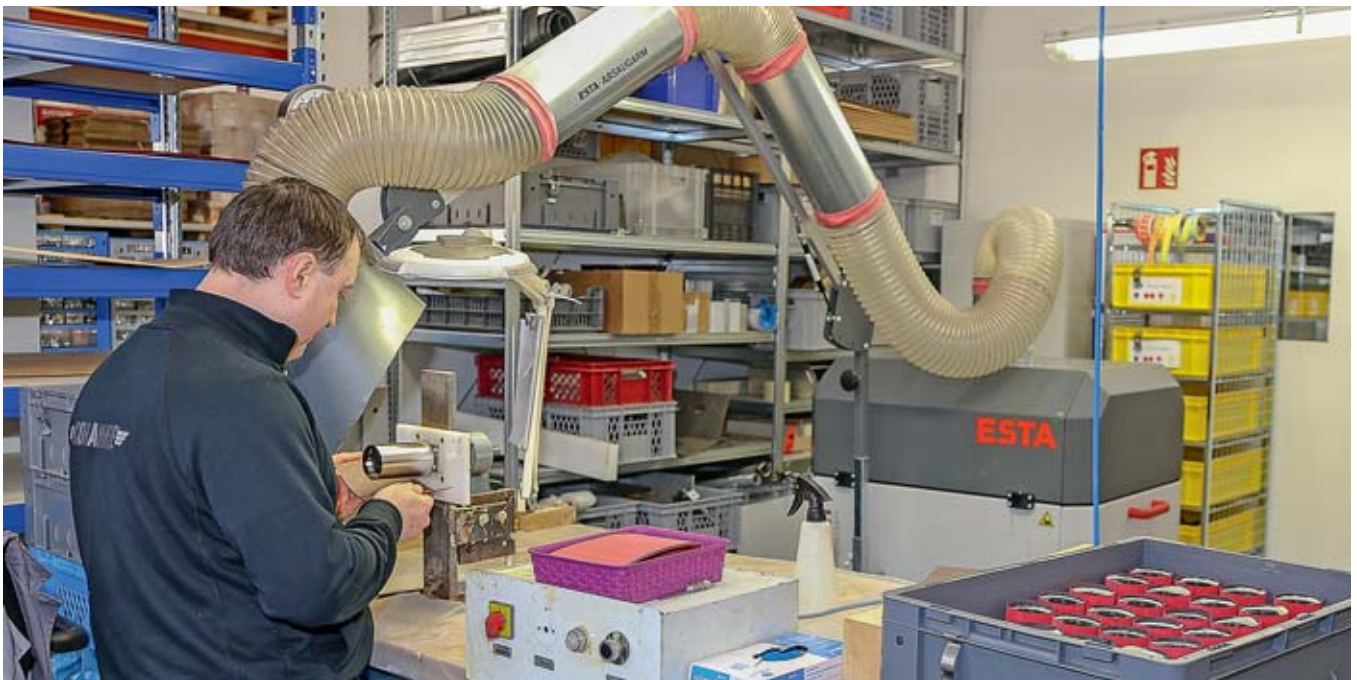
Der Geruchsfilter Vacuumat von Esta erfasst mit einem Absaugarm wirkungsvoll unangenehme Gerüche und Schadstoffe, die beim Bearbeiten der Werkstücke entstehen
