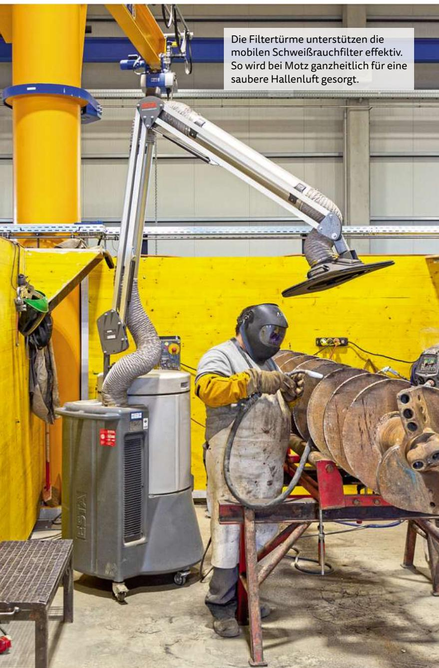
Die Filtertürme unterstützen die mobilen Schweißrauchfilter effektiv. So wird bei Motz ganzheitlich für eine saubere Hallenluft gesorgt.
