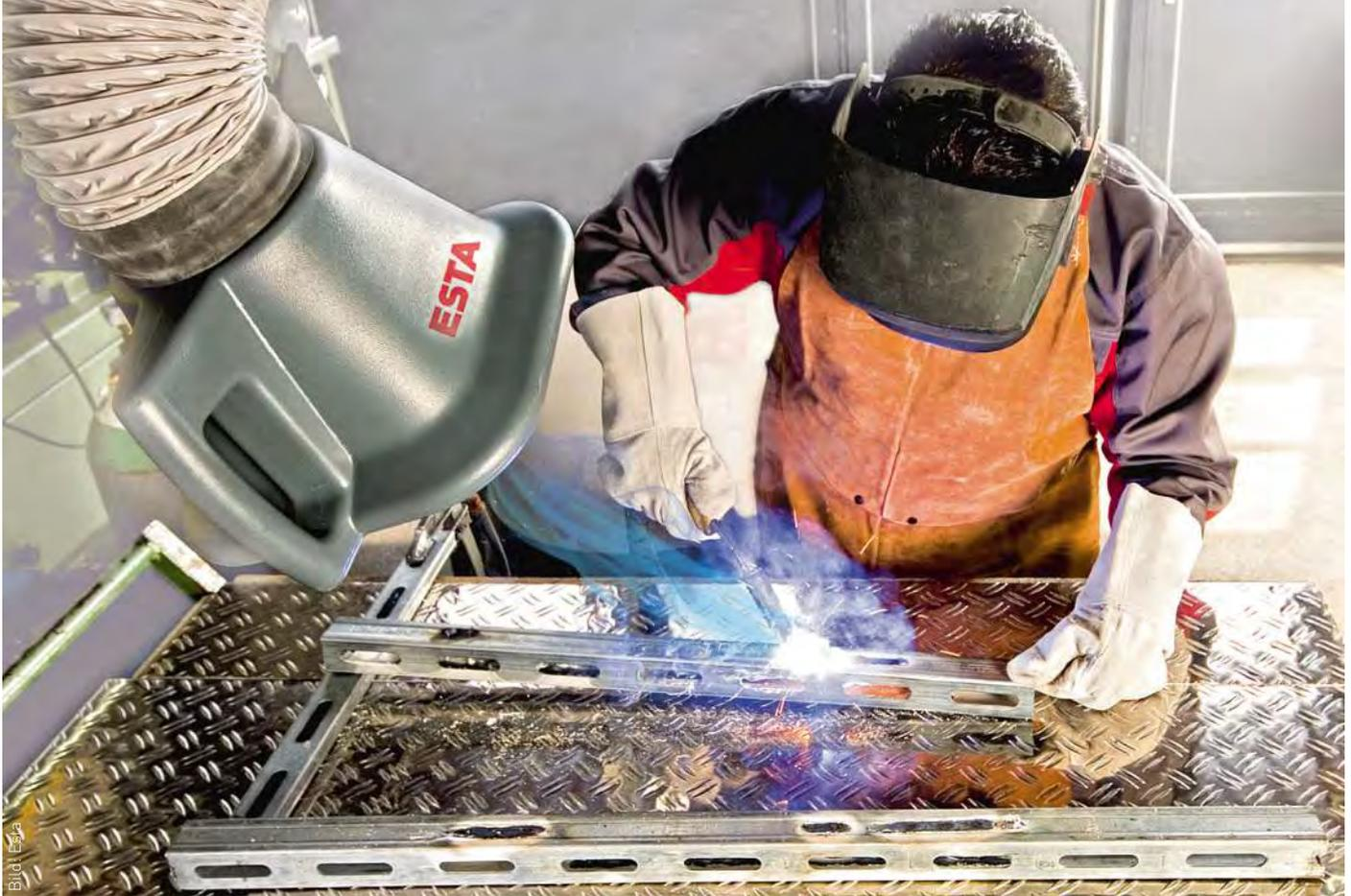
*In der Praxis wird der Schweißrauch am häufigsten direkt an der Entstehungsquelle erfasst. Absauggeräte und -anlagen mit flexibel einstellbaren Absaugarmen oder großflächigen -hauben sind hierbei erste Wahl.*
