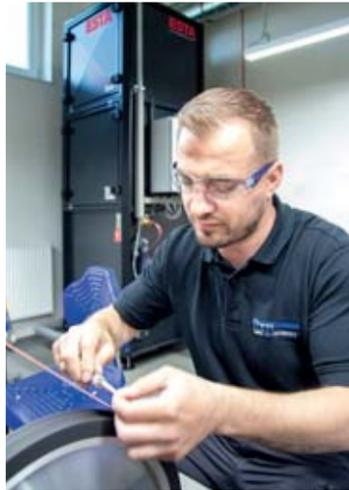
Mit dem Esta-Nassabscheider können die anfallenden Titanschleifstäube und Funkenflug mittels Wasserabscheidetechnologie schnell unschädlich gemacht werden.
