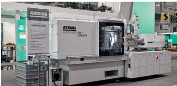
Eine innovative Anwendung für die Medizintechnik demonstriert ein elektrischer Allrounder 520 A Ultimate: Die Hochleistungsmaschine produziert auf der NPE 2024 im Rahmen eines Gemeinschaftsprojekts IML-Zentrifugenröhrchen.
