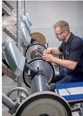
Der Nassabscheider ist als zentrale Einheit mit allen vier Arbeitsplätzen via Wickelfalzrohrleitung verbunden.
