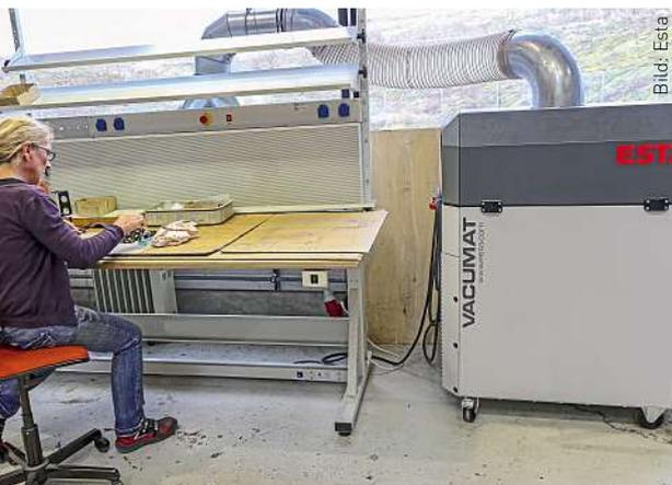
An einem Klebearbeitsplatz saugt ein Vacumat mit Aktivkohlefilter die entstehenden Gerüche und Klebedämpfe ab. Der Vacumat ist über eine Rohr-Schlauch-Leitung mit der Rückwand verbunden und entlässt die gefilterte Luft zurück in den Arbeitsraum.
