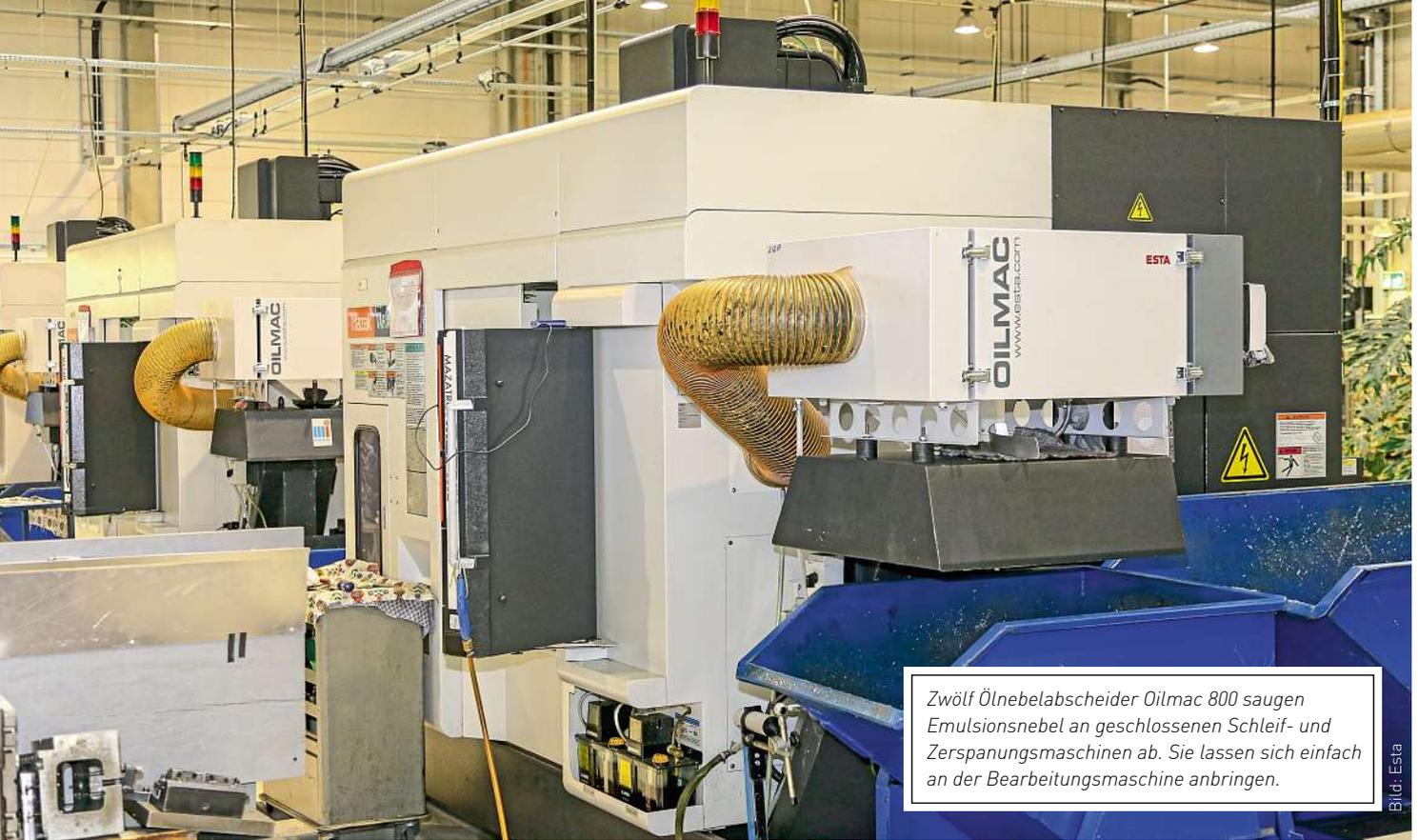
Zwölf Ölnebelabscheider Oilmac 800 saugen Emulsionsnebel an geschlossenen Schleif- und Zerspanungsmaschinen ab. Sie lassen sich einfach an der Bearbeitungsmaschine anbringen.
