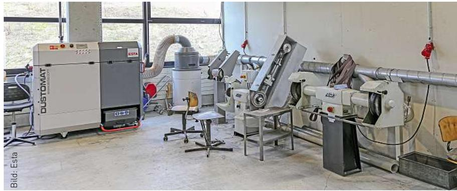
An drei Schleifmaschinen sorgt ein Dustomat mit Wasservorabscheider für die Absaugung. Der Wasservorabscheider dient der Abscheidung von Funken und groben Partikeln, um die Hauptfiltermedien zu schützen und das Risiko eines möglichen Filterbrands zu reduzieren.
