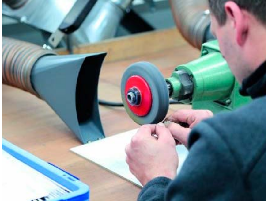
An den Schleifarbeitsplätzen werden Absaughauben eingesetzt, die den anfallenden Metallstaub direkt am Entstehungsort erfassen und beseitigen
