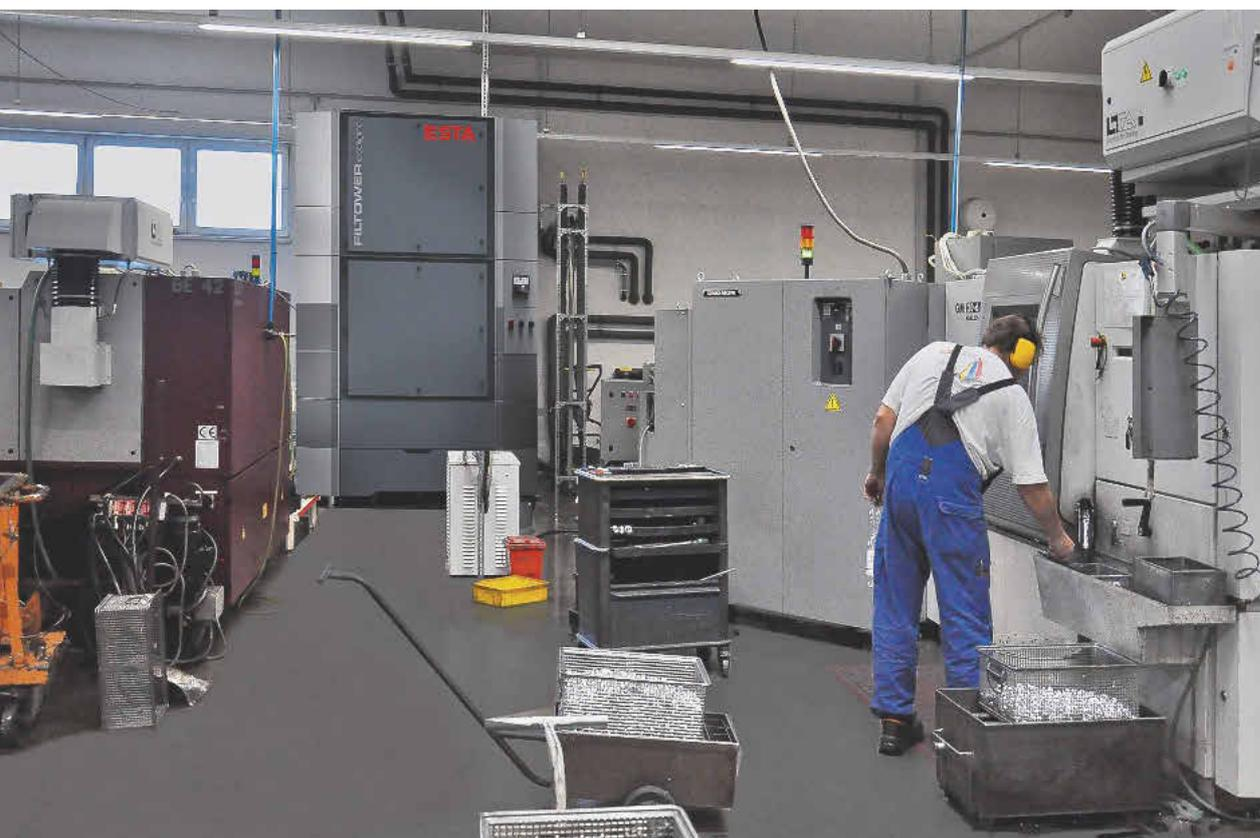
Bei den Bohr- und Fräsprozessen entsteht Ölnebel. Die beiden Filtertürme ergänzen die bestehenden Absaugungen und sorgen für eine reine Hallenluft.
