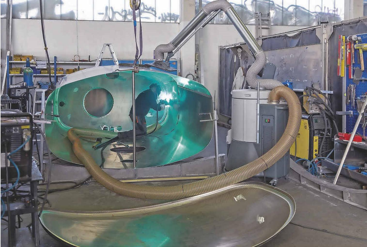
Die mobilen Schweißrauchfilter sind äußerst flexibel im Einsatz: Die Schweißer nehmen den PU-Absaug Schlauch einfach mit in den Tank, zeitgleich erfasst ein Absaugarm, der an einer Fertigungsöffnung positioniert ist, den schädlichen Rauch von oben. Bild: Esta
