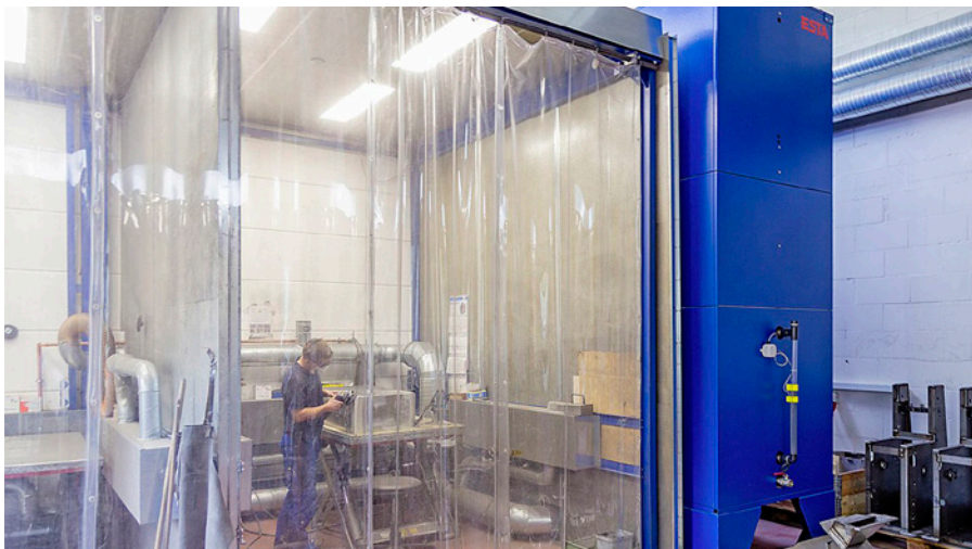
▲ Bild 3. An den vier Schleifkabinen sind Nassabscheider installiert, die die teilweise explosionsfähigen Stäube sicher erfassen und abscheiden. (Bilder: Esta)
