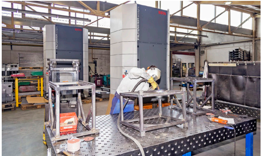
▲ Bild 2. In der Schweißerei bei Kilgenstein stehen zwei Filtertürme, die die Hallenluft von Schweißrauch befreien.
