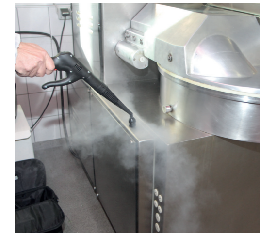
Der Dampf Drache von Dampftec rückt Fett, Schmutz, Bakterien, Viren und Pilzen mit bis zu 185 °C heißem Dampf zu Leibe. Foto: Dampftec
