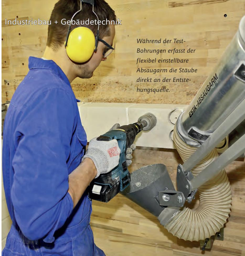
Während der Test-Bohrungen erfasst der flexibel einstellbare Absaugarm die Stäube direkt an der Entstehungsquelle.
