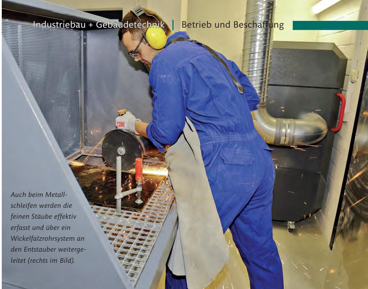
*Auch beim Metallschleifen werden die feinen Stäube effektiv erfasst und über ein Wickelfalzrohrsystem an den Entstauber weitergeleitet (rechts im Bild).*
