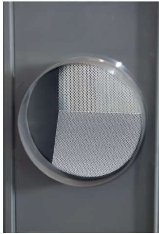
Der integrierte Prallabscheider fängt größere Teilchen bei Eintritt in das Gerätegehäuse ab
