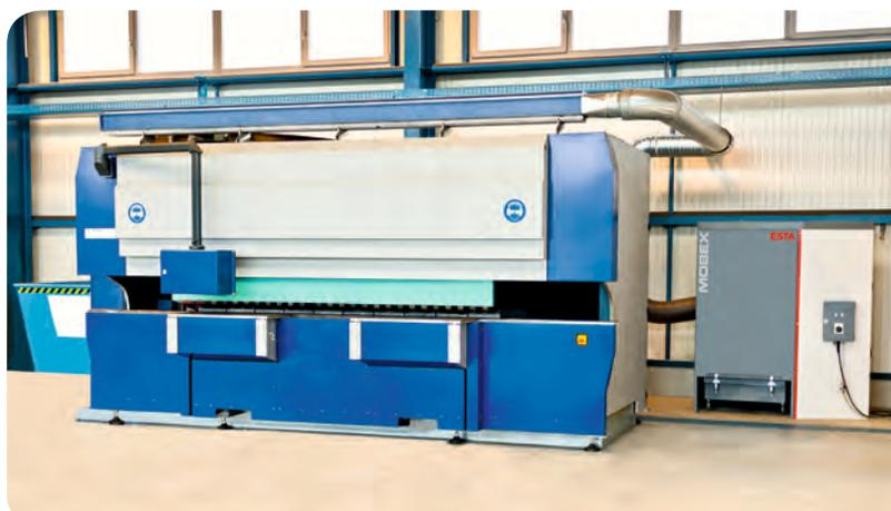
MOBEX P-24 équipant une ponceuse à bande pour chanfrein
