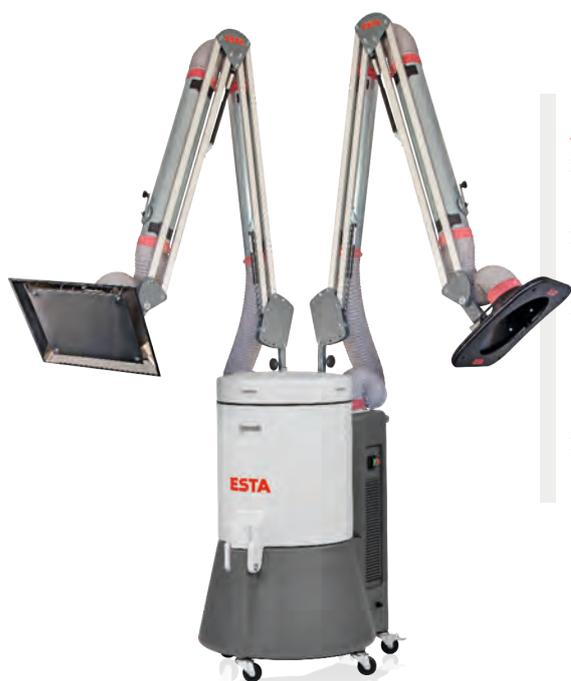
Filtre pour fumées de soudure SRF K-15 en version mobile
