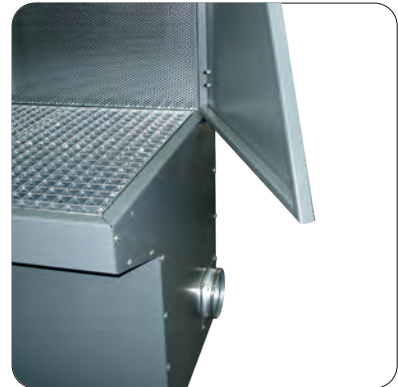
Aufgeklapptes Seitenteil für größere Werkstücke
