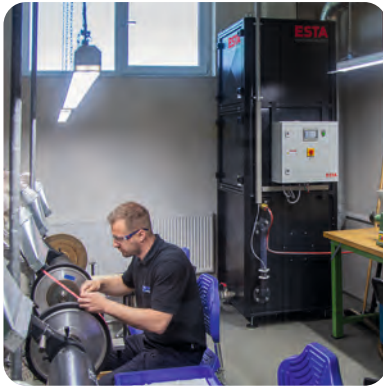
Nassabscheider DUSTOMAT HYDRO in der Schleiferei
