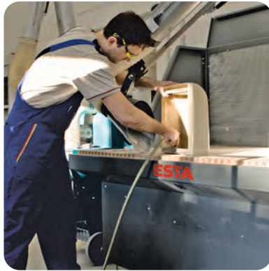
Absaugtisch mit Holzplattenrost und Absaugarm
