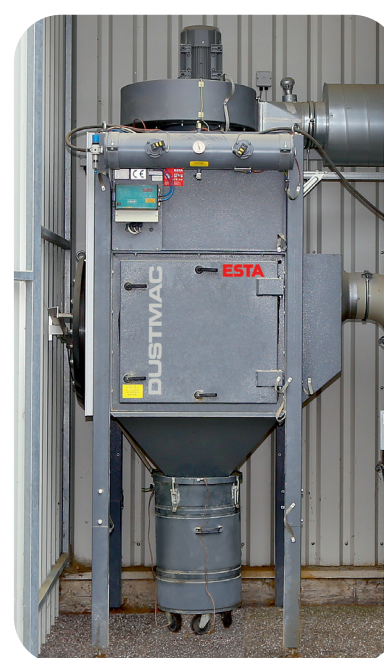
Absauganlage DUSTMAC F in der Chemie-Industrie
