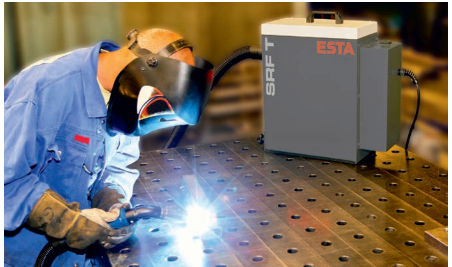
SRF T-2, Direktabsaugung an einem Schweißbrenner
