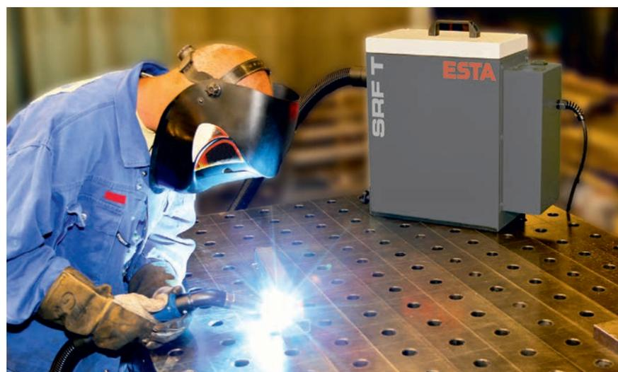
SRF T-2, Direktabsaugung an einem Schweißbrenner
